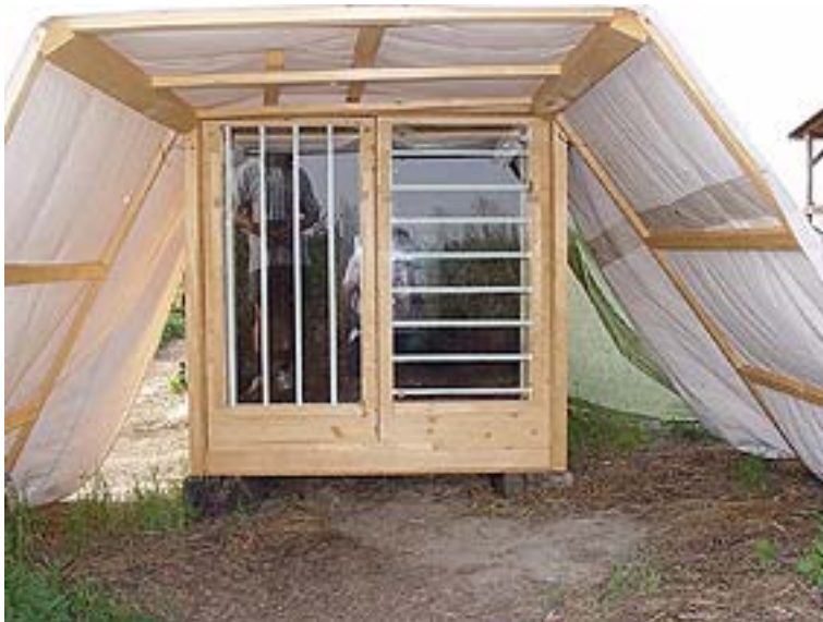
Abbildung 8: Sonnenplane zur Abschirmung des vor dem Tunnel liegenden Bereichs gegenüber direktem Sonnenlicht
