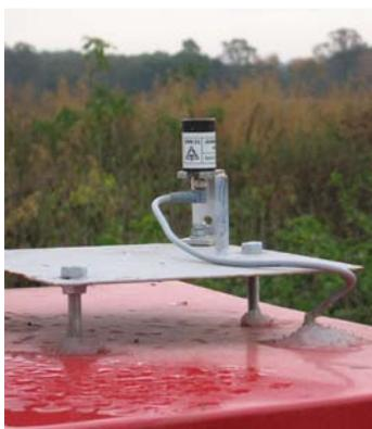
Abbildung 8: Pyranometer 1 zur Messung der Globalstrahlung
