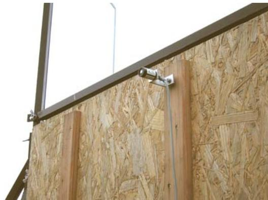
Abbildung 9: Pyranometer 2 zur Messung der Strahlung hinter den Versuchsscheiben.
